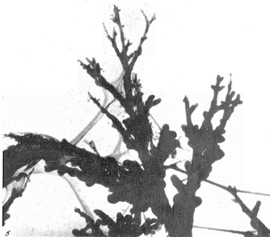
Рис. 1. a — фотография вольфрамовой проволоки диаметром 40 мкм, активированной парами бензонитрила при 1200°, полученная с помощью сканирующего электронного микроскопа. Длина микроигл \sim 20 мкм. б — фотография микроигл, полученная с помощью трансмиссионного электронного микроскопа. На иголочках и между ними виден тонкий слой D -глюкозы (более слабое потемнение), которая была нанесена из 0,01 М водного раствора. Концы тонких игл кое-где сгинуты друг к другу чем-то вроде глюкозных нитей (образовавшихся после испарения воды и поэтому несколько изогнутых)
